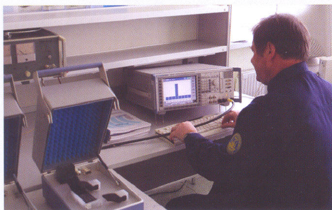
Вимірювання технічних параметрів терміналів стільникового зв'язку
