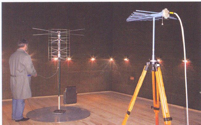
Випробування в безлунній камері
