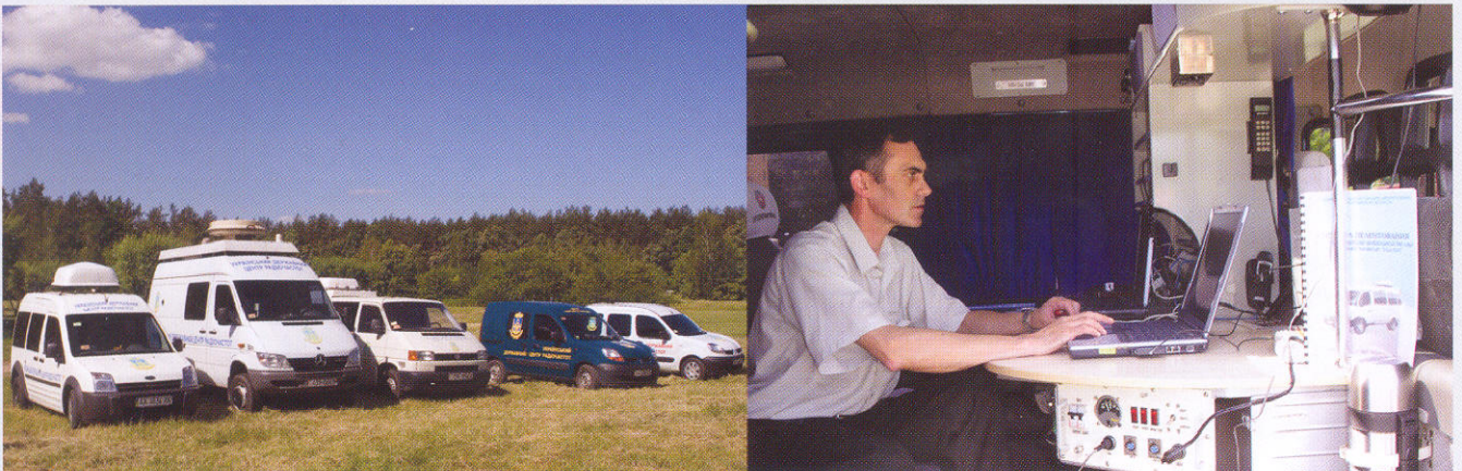
Мобільні комплекси радіочастотного моніторингу. Зовнішній вигляд та встановлене обладнання
